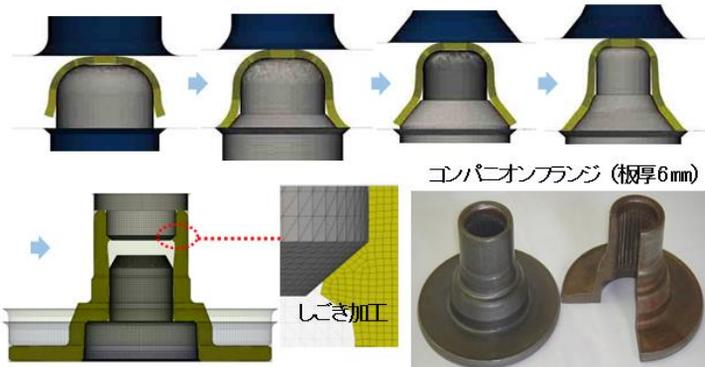
【鑄造から板鍛造への工法転換による生産性向上】
